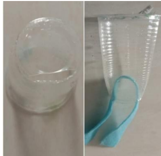
Gambar 5 Pelubangan alas gelas plastik dan pemasangan kain flannel (dok. pribadi)
