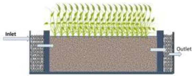
**Gambar 1. 22** Lahan basah buatan tipe aliran permukaan(Parde et al., 2021)
