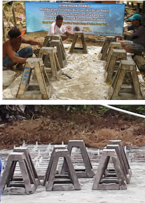
Gambar 7.6. Proses pencetakan beton piramid
