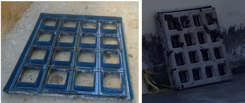
Gambar 7.4 Cetakan beton frame kotak bersekat
