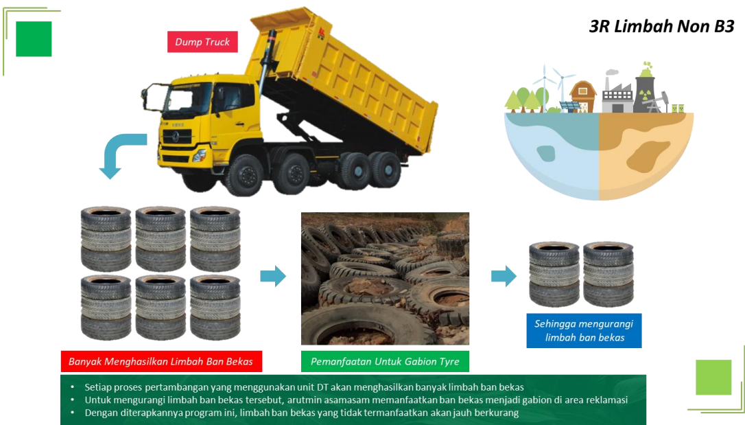
Gambar. 7. Ilustrasi Gabion Tyer sebagai Pengendali Erosi
