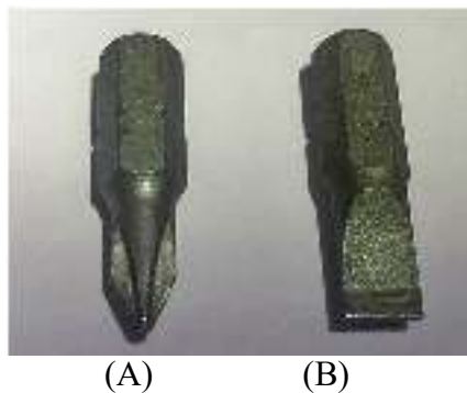
Gambar 4. Jenis-jenis ujung obeng. Pada gambar (A) merupakan ujung obeng berbentuk plus sedangkan pada gambar (B) merupakan ujung obeng berbentuk minus.
