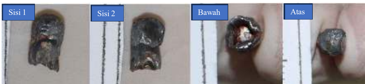
Gambar 3. Anak peluru kedua (a) Kubah, diameter 4.36 mm dan tinggi 3.69 mm, (b) Pinggang, diameter 3.96 mm, dan (c) Bawah, diameter 4.11 mm dan tinggi 3.33 mm.
