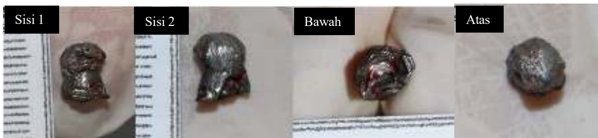
Gambar 2. Anak peluru pertama (a) Kubah ( flattened nose ), diameter 5.43 mm dan tinggi 2.97 mm, (b) Pinggang, diameter 4.29 mm, dan (c) Bawah, diameter 5.70 mm dan tinggi 3.26 mm.
