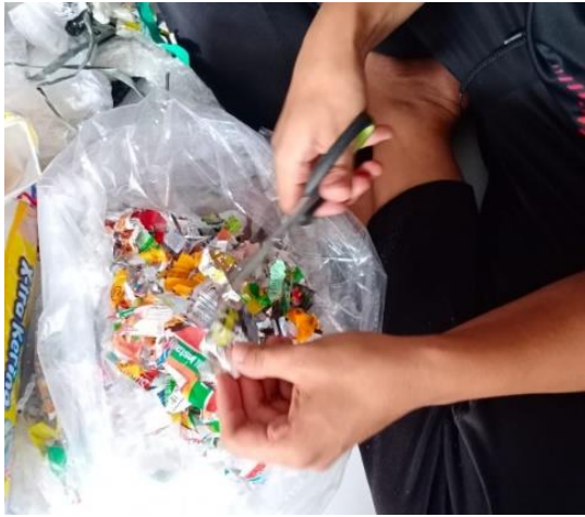
Gambar 3. 9 Menggunting plastik dalam pembuatan ecobrick Sumber: khairunnikmah.com
