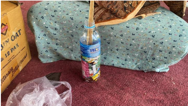
Gambar 3. 11 Memadatkan sampah plastik dalam pembuatan ecobrick
