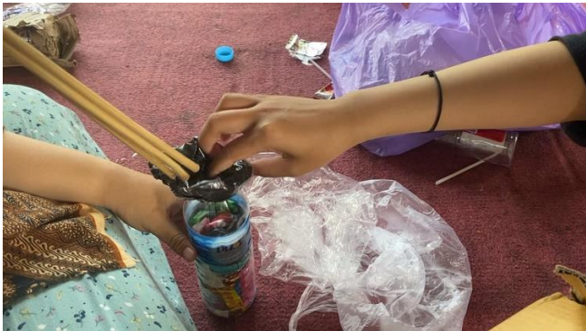
Gambar 3. 10 Memasukkan sampah plastik dalam pembuatan ecobrick
