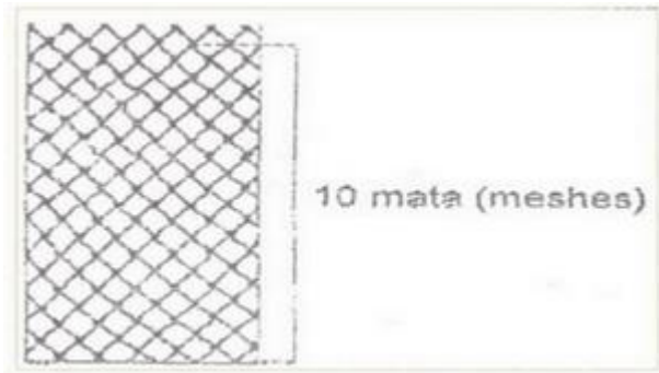
Gambar 2.6. Mengukur panjang sepuluh mata jaring
