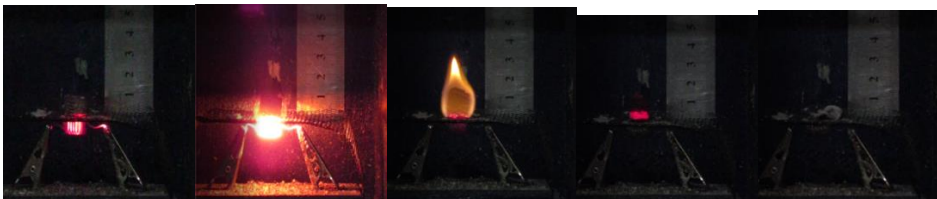
Gambar 4. Pengujian Karakteristik Pembakaran Pellet Kayu Gelam
