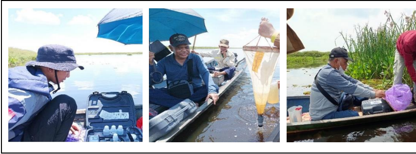
Gambar 3.2. Pengukuran parameter kualitas air, plankton dan benthos di rawa Danau Bangkai
